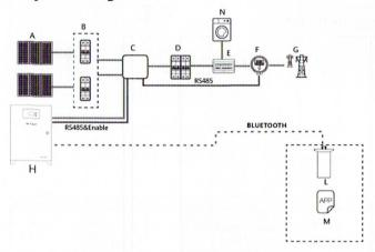
(A) PV module (D) AC switch
