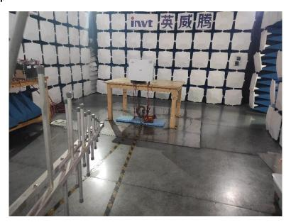
Test Setup (30MHz-1GHz)
